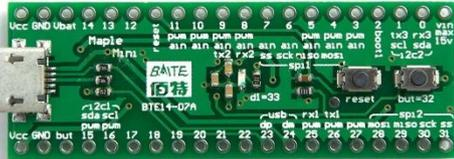
Alle Experimente wurden mit der Standard-Wire-Library der Arduino-Umgebung ausgeführt. Als Hauptprozessor wurde ein Maple Mini von Baite verwendet.
