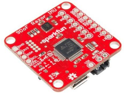
Der 9DOF-Sensor MPU9250 liefert sehr präzise Daten, allerdings zunächst ohne Sensorfusion. Diese kann durch einen Board-eigenen Prozessor, den DMP, ausgeführt werden. Der MPU9250 ist eine Kombination aus dem Magnetometer AK8963 und dem 6DOF-Sensor MPU6500.
