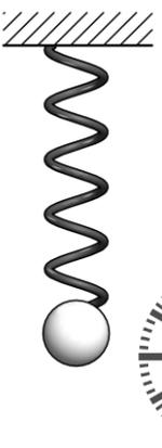
Eine Uhr soll gebaut werden. Dazu benötigt man ein Federpendel mit der exakten Frequenz von exakt einem Hertz. Gegeben ist eine **Masse von 0,76kg**. Berechne den Aufbau des Federpendels.
