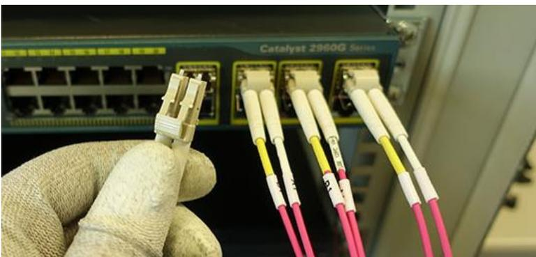
Abbildung 1: Lichtwellenleiter-Kabel an einem Switch (Internetknoten)
