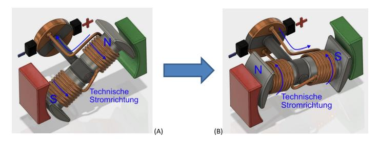
Der Rotor dreht sich im Uhrzeigersinn.
